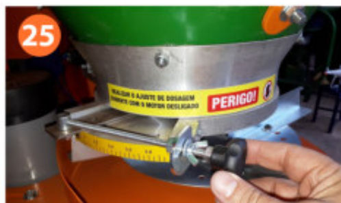
D) Abrir o registro em uma regulagem dosadora qualquer (foto 25).
