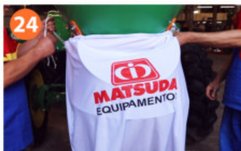
B) Fixar a bolsa coletora de forma a envolver toda a frente (foto 24)
