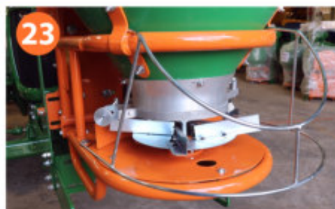
A) Fixar o suporte da bolsa coletora na frente da sementeadeira (foto 23).
